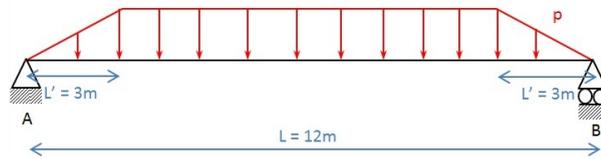
FIGURE 1: Charge trapézoïdale sur poutre isostatique
